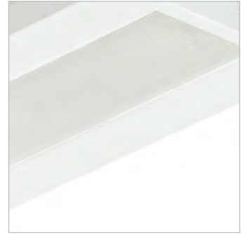
Optique VAR-PC conforme EN12464-1: L < 3'000 \text{ cd/m}^2 à \gamma > 65^\circ , UGR R 19 pour places de travail informatisées
