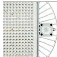
In der neuen PIR-Version wird die Leuchte mit integriertem Bewegungssensor geliefert. Die fest voreingestellte Steuerung schaltet automatisch nach 15 min ohne Bewegung auf 25% des Lichtstromes. Damit sind zusätzlich deutliche Kosteneinsparungen möglich.
