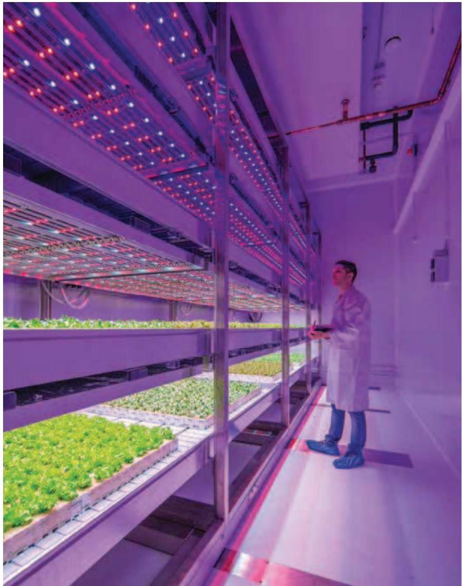
De klimaatcellen hebben vier teeltlagen. Het is mogelijk om iedere laag een eigen lichtrecept toe te dienen.
