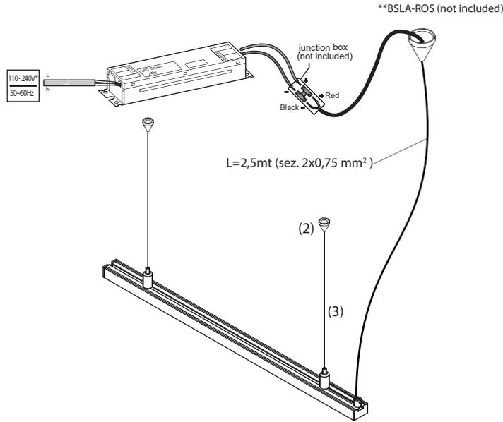
**Esempio di collegamento (connessione in parallelo)
