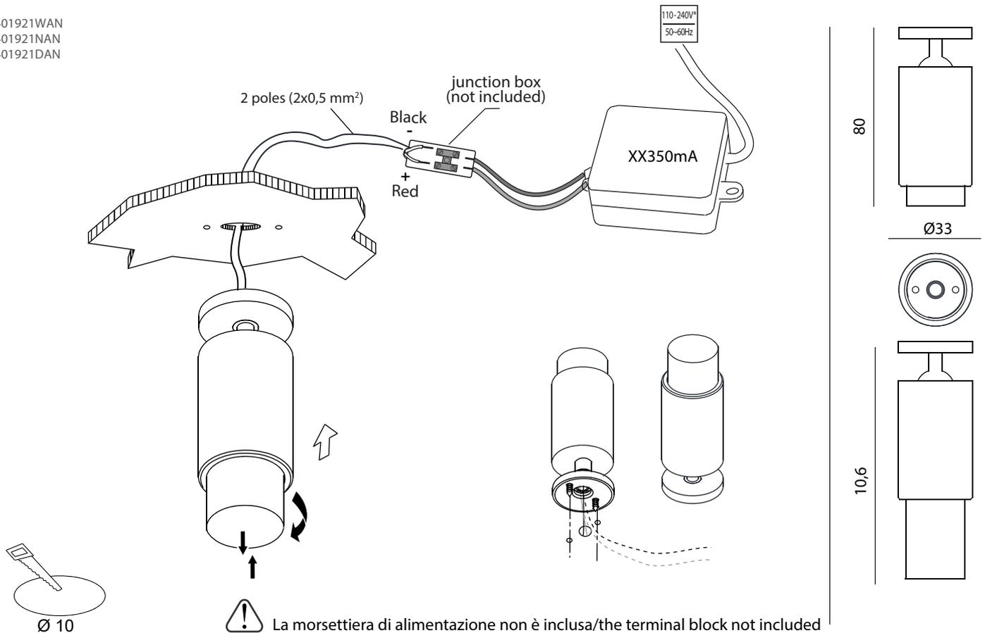
**Esempio di collegamento (connessione in serie)/
