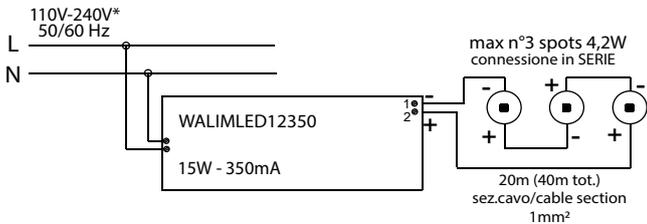
\* Verificare la tensione di ingresso supportata dagli alimentatori / Verify the input tension supported from drivers
