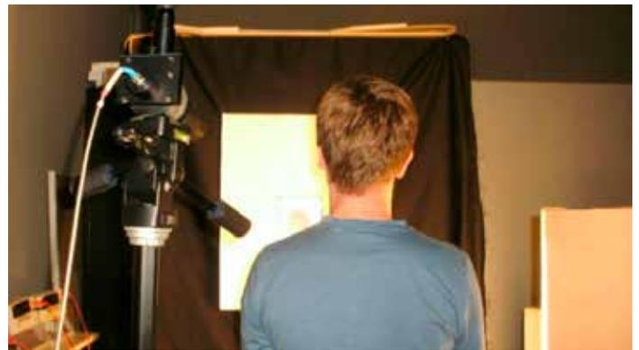
**Figura 1:** Allestimento del test con un telescopio connesso a uno spettrografo sulla sinistra, e sulla destra una scatola luminosa dentro la quale i soggetti dovevano guardare per cancellare il colore dalle loro retine.
