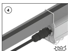
4) Connect the female connector to the main power cable and connect this main power cable to the power grid. / Montez la fiche femelle sur le câble d'alimentation et connectez ce câble d'alimentation sur le réseau électrique.
