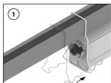
1) Hook on 2 mounting brackets (**A and A**) onto the C-profile. Put the 1st module over the C-profile. Slide the 1st bracket (**A**) into the end cap of the module. / Accrochez 2 étriers (**A et A**) sur le profilé C. Mettez le premier module sur le profilé C. Glissez le premier étrier (**B**) dans l'extrémité du module.
