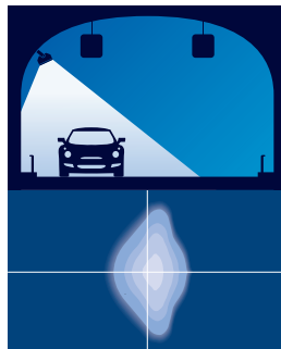
DTA Lichtverdeling Asymmetrisch (standaard)
