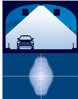
DTS Lichtverdeling Symmetrisch (standaard)
