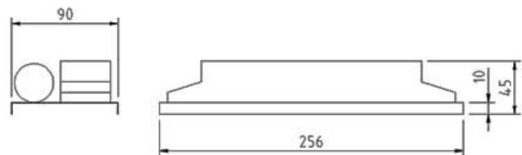
Dimensiones de placa para equipo de emergencia
