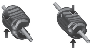
ПОСТАВЯНЕ / ПРЕМЕСТВАНЕ АКТИВИРАНЕ НА ЗАХВАЩАНЕТО Фигура 1: Принадлежност за захващане на дезилета TorqMax
