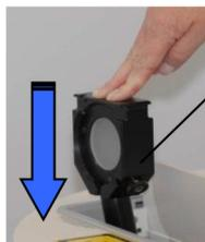
Repousser le détecteur d'énergie dans l'appareil et fermer le couvercle de protection
