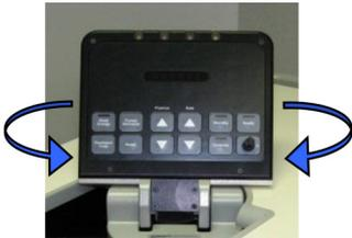
Wird das Bedienfeld angehoben, kann es für leichtere Zugänglichkeit um 90° nach links oder rechts gedreht werden.
