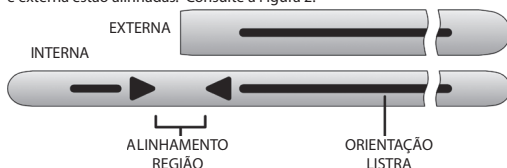
Figura 2: Características das marcações na Bainha dilatadora manual SightRail
