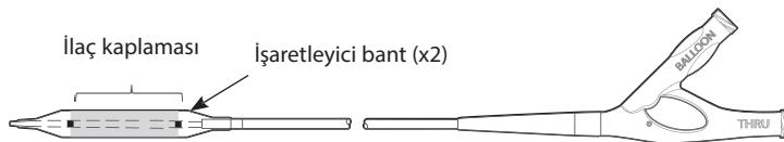
Kateter 0,89 mm (0,035 inç) kılavuz telle uyumludur. Her cihazın kateterin ilaçla kaplı balon kısmı üzerinde koruyucu bir kılıf vardır. Her cihaz için ürün etiketi üzerinde bir esneklik tablosu dahil edilmiştir.
