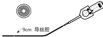
图2：快速交换型导管（RX）
